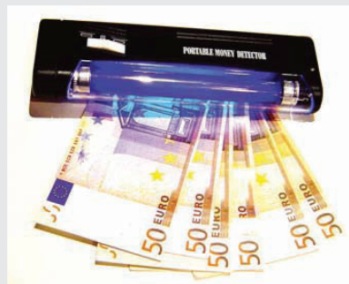
Fig. 19: Detector de billetes falsos, que usa luz ultravioleta.
