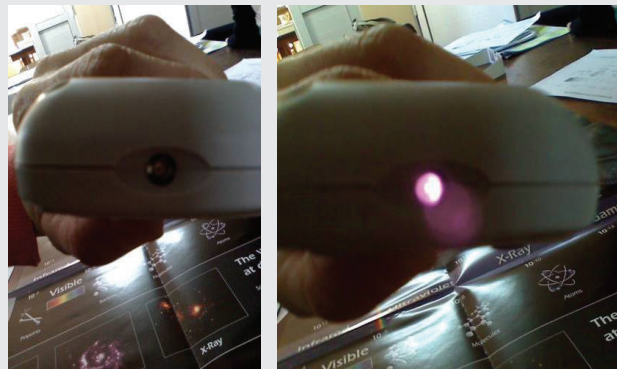
Fig. 10a: Control remoto encendido si lo miramos a simple vista, Fig. 10b: Control remoto si lo miramos a través del teléfono móvil.
