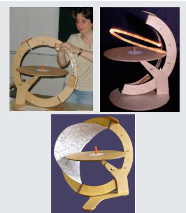
Fig. 27a: Simulador de mayor tamaño hecho en madera. Fig. 27b: Con una cámara fotográfica y una larga exposición es posible simular la trayectoria solar. Fig. 27c: Simulador estelar en madera (Fotos: Sakari Ekko).
