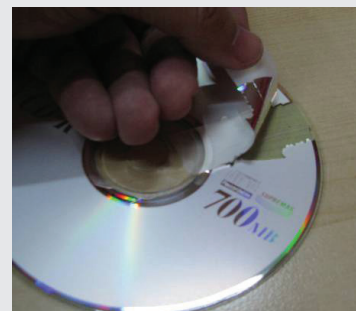
Fig. 3b: Retirando la capa metálica del CD, con cinta adhesiva.
