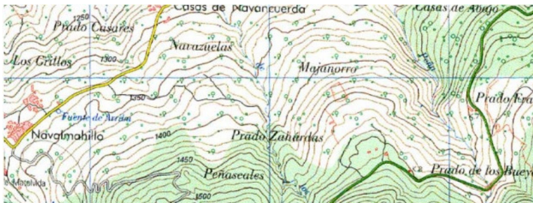
Mapa topográfico. Las curvas de nivel están en color marrón. Las líneas verticales y la horizontal de color azul corresponden la cuadrícula UTM.
