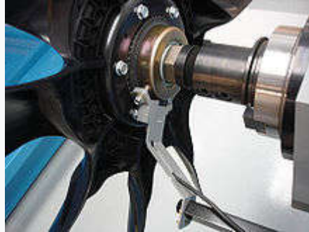
Ventilador de un motor con un sensor Hall, usado en refrigeración industrial.
